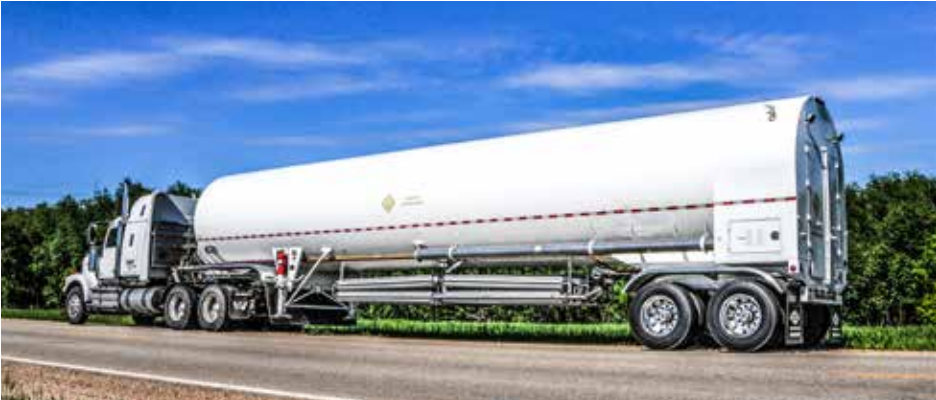
13,000 GALLON - LNG - 96" DIAMETER - 70 PSI
